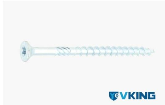
Gamme utilisée dans les constructions en bois massif épicéa, pin, sapins, de type maison ossature bois, charpentes, structures de jeux et abris. L'éclatement du bois est réduit grâce à une pointe cutting. La contrainte, diminuée, grâce au fraisage intermédiaire. Aucun préperçage nécessaire.
