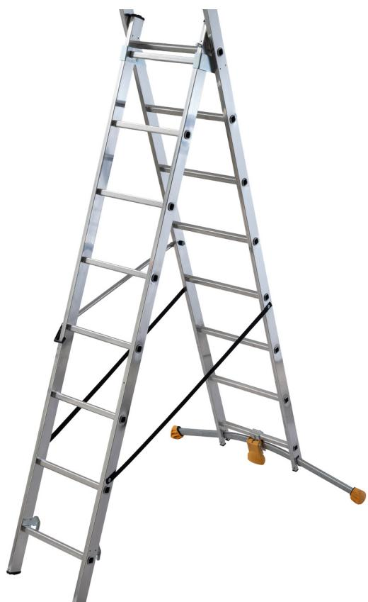
■ Échelle transformable 2 plans en aluminium - Fonction coulissante à main - Utilisation rattrapage de niveau dans les escaliers - Compensation des terrains en pente grâce au système pédale "Lot-system" - Échelons striés antidérapants - Articulations renforcées en acier galvanisé - Embouts ultra larges emboitables antidérapants - Sangles et bras de sécurité - Charge garantie 150 kg - Norme EN 131
