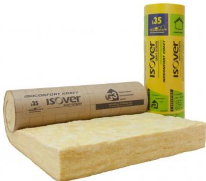
Panneau semi-rigide à dérouler en laine de verre, revêtu d'un surfaçage kraft, quadrillé tous les 10 cm. Peut être posé en une couche ou associé à un Isoconfort 35 entre chevrons.
